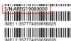
Год и месяц изготовления обозначены в серийном номере четвертым и пятым символом соответственно.
